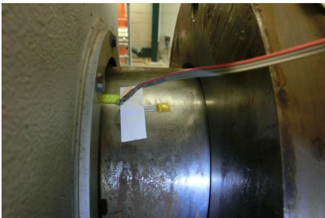
Abb. 1: Befestigung des Dehnungsmessstreifens (DMS) auf der Welle
