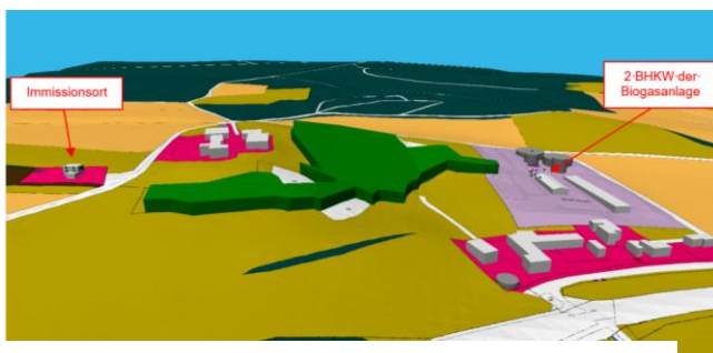
Abb. 1: 3D-Modell mit Lage der Schallquellen und des Immissionsortes
